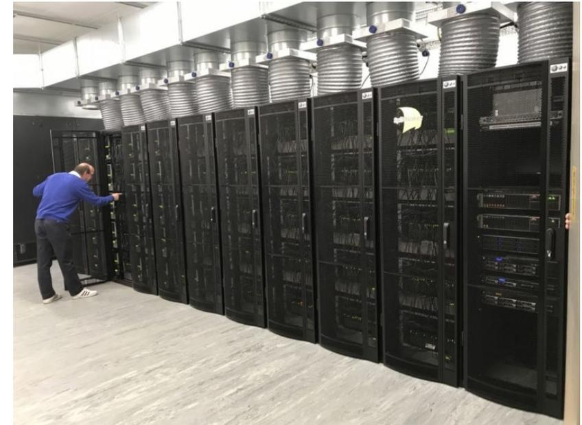
Суперкомпьютер Spiking Neural Network Architecture
