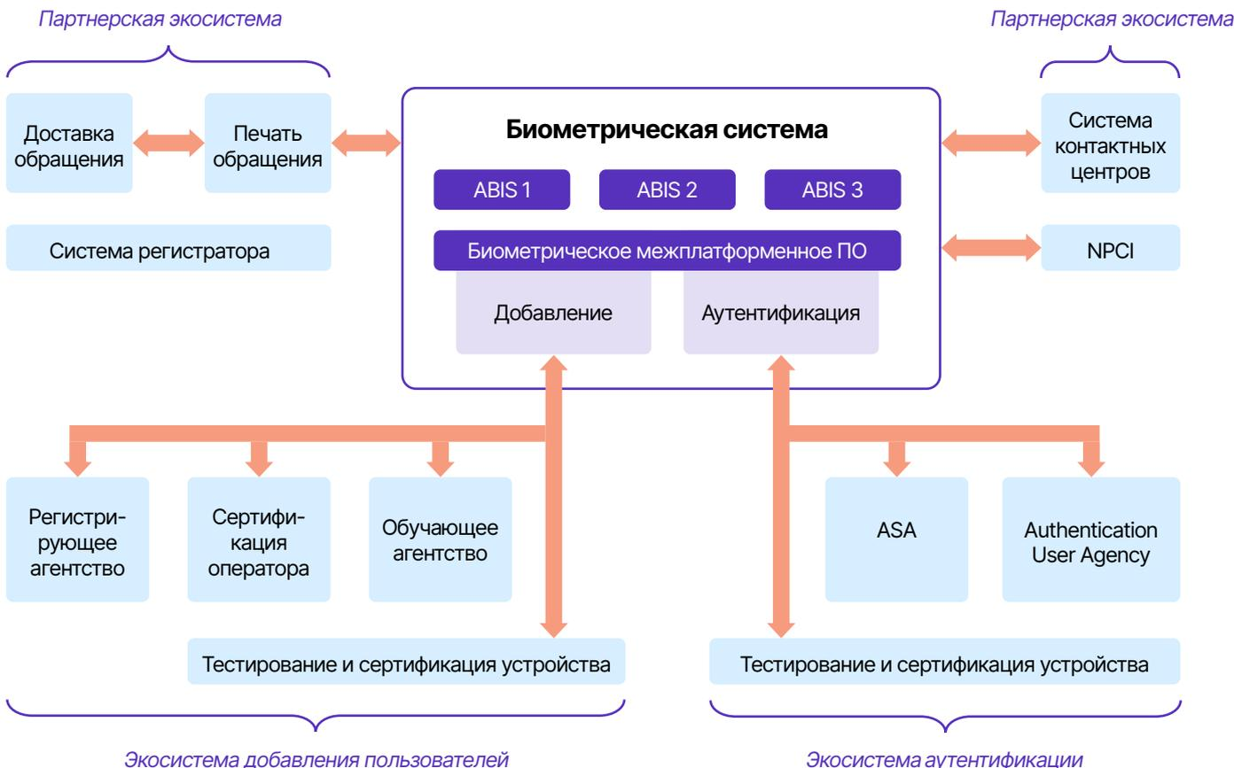
**ABIS** – автоматические биометрические системы (Automatic Biometric Identification System) от разных разработчиков, объединённые в одну Multi-ABIS.
